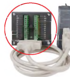
I-87018ZW-G/S2 CR= I-87018ZW подключается к DN-1822 вместе с комплектом CD-2518D
