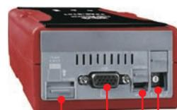
microSD Гнездо, VGA-порт, Поворотный выключатель, USB-клиент
