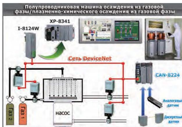
Система использует контроллер XP-8341 и модуль I-8124W в качестве центра управления устройствами удаленного ввода-вывода. I-8124W выступает в роли DeviceNet master и принимает данные с устройств удаленного ввода-вывода, включая данные от пневматического клапана "MKS 683" и устройства ввода-вывода производства Beckhoff.
