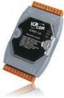
HART-710 – это шлюз HART master в Modbus slave. Он позволяет легко master-устройствам Modbus получить доступ к slave-устройствам HART. С целью облегчить диагностику и конфигурацию HART-сети, предоставляется утилита с дружественным интерфейсом.
